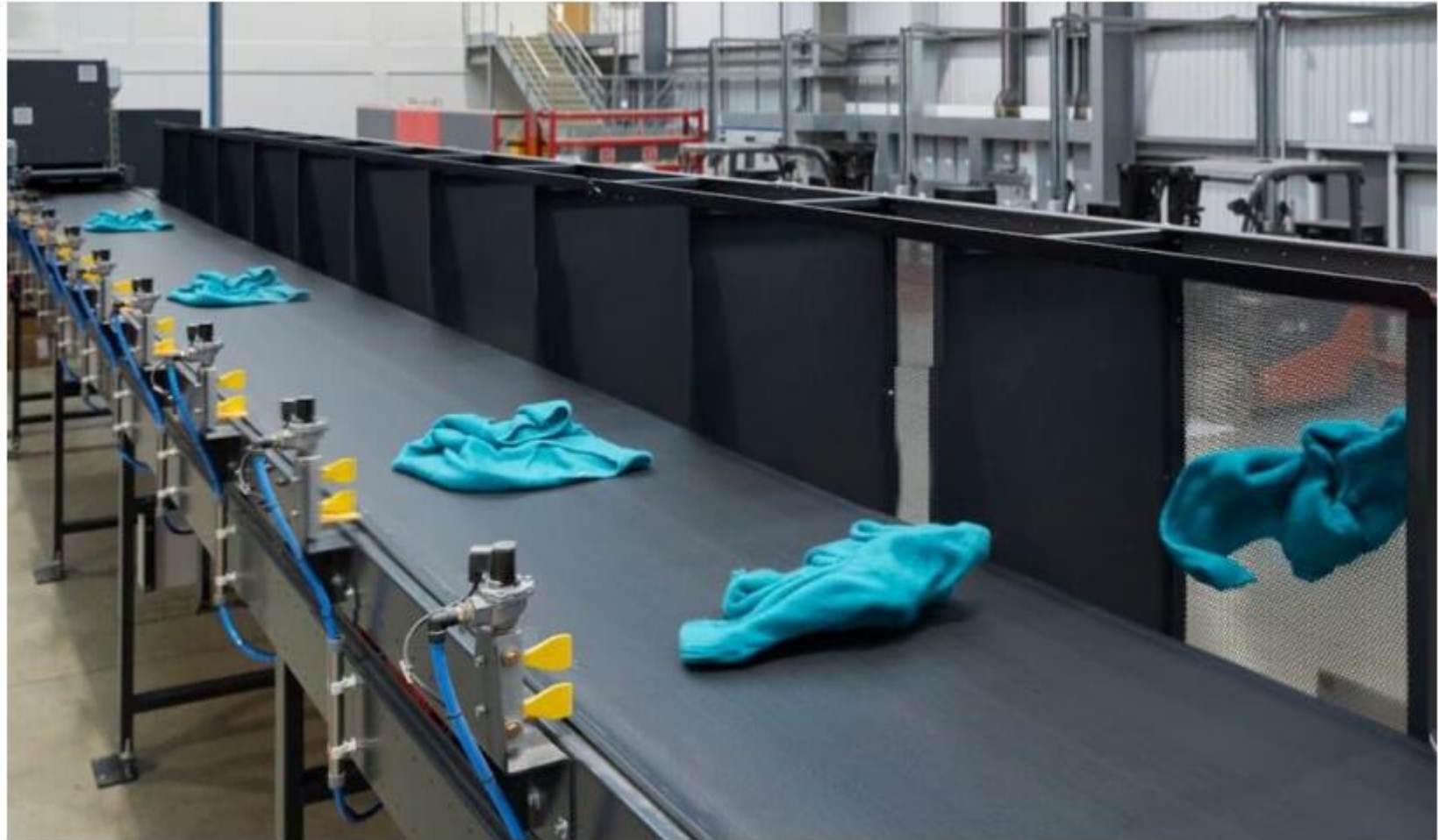
▲ 컨베이어벨트를 이용해 의류폐기물을 이동하고 분류하는 파이버소트 기술. ©Salvation Army Trading Company, 트위터
